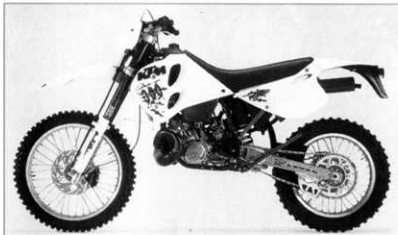
Δ KTM 300 GS modèle 1993 de présentation blanche avec selle de couleur bleue. L'enveloppe de l'échappement arrière est anodisée rouge. Nouveaux équipements : nouveaux tés un carburateur Keihin PWK 39 et un étrier avant Brembo à double piston et disque de frein de diamètre 260 mm.
