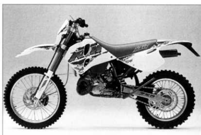
Δ KTM 250 EXC modèle 1994. Appelée plus communément EGS ou GS, ces modèles restent toujours de présentation blanche avec selle bleue. Les décors latéraux sont très différents comme en témoigne la photo. Moteur plus léger et renforcement de l'embellage et de la boîte de vitesses constituent les principales modifications moteur. Nouvel étrier de frein arrière permettant une dépose rapide des plaquettes.
